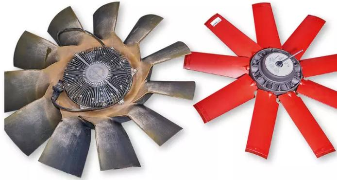
Links der Fendt-Lüfter mit der großen Visco-Kupplung. Rechts der Cleanfix mit Flügelwinkel- (Bildquelle: Uhlig)
